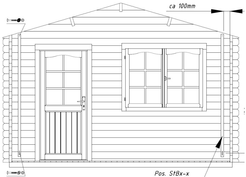
Installatie van de stormankers:
