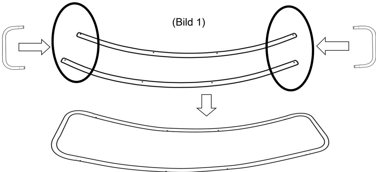
**Schritt 3: Zusammenbau Rückenstütz Rohr (J)**
