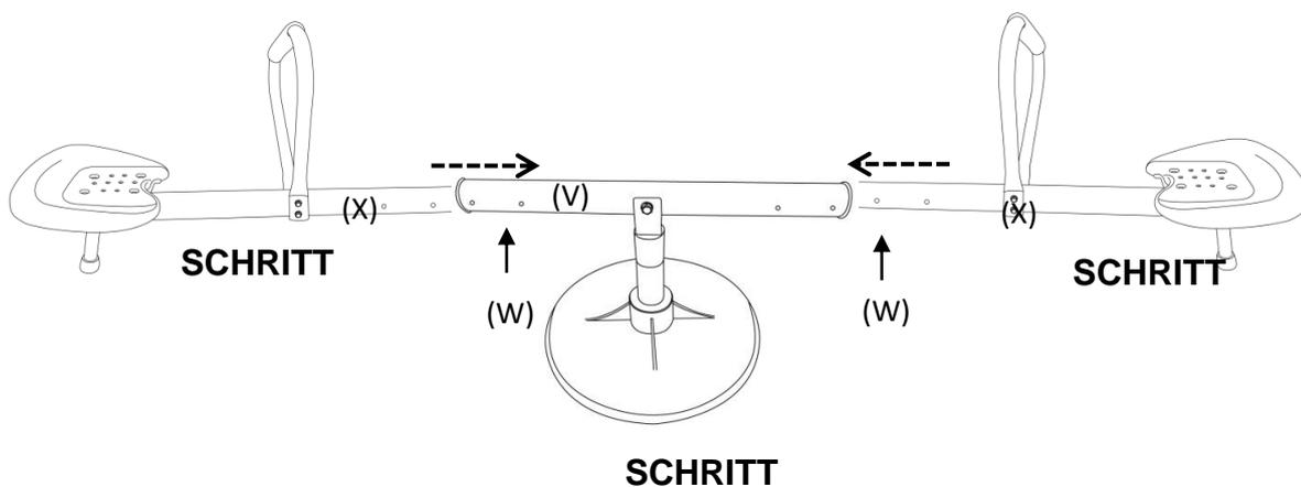
★ **HINWEIS:** Stellen Sie sicher, dass die Schraubenlöcher am langen Kunststoffrohr (W) perfekt zu den Schraublöchern der Seitenstange (X) passen.
