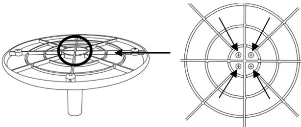
\* Bitte sicherstellen, dass die Löcher am unteren Stützrohr von den 4 Schrauben zu den 4 Schraubenlöchern am Sockel übereinstimmen.
