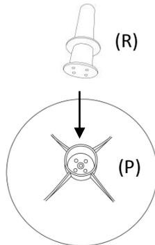
1 - 2. Halten Sie das untere Stützrohr (R) und den Sockel (P) fest und drehen Sie es in die entgegengesetzte Richtung. Befestigen Sie das untere Stützrohr (R) mit dem Sockel (P) (N x 1 + I x 1 + O x 1).
