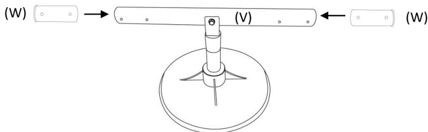
★ HINWEIS: Stellen Sie sicher, dass die Schraubenlöcher am langen Kunststoffrohr (W) perfekt zu den Schraubenlöchern der Hauptmittelschiene (V) passen
